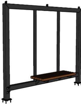
**Quadro:** uma goleira 220cm de altura e 270cm de largura, conexão tubo quadrado de aço galvanizado 100mm x 100mm - 3,00mm cortes a 45° soldados com solda corrida em solda mig garantindo que fique selado em todas as faces.
